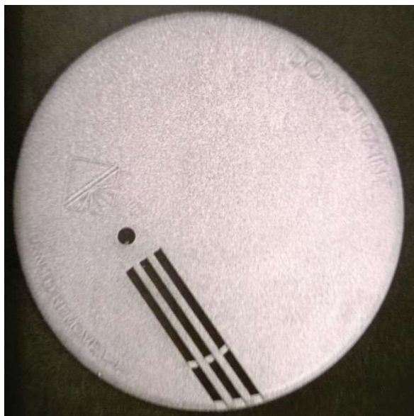
Billede 7: Kategori 2 røgdetektor af typebetegnelsen JO-EL mini MTS-168 (radioaktivitetssymbol findes på bagsiden).
