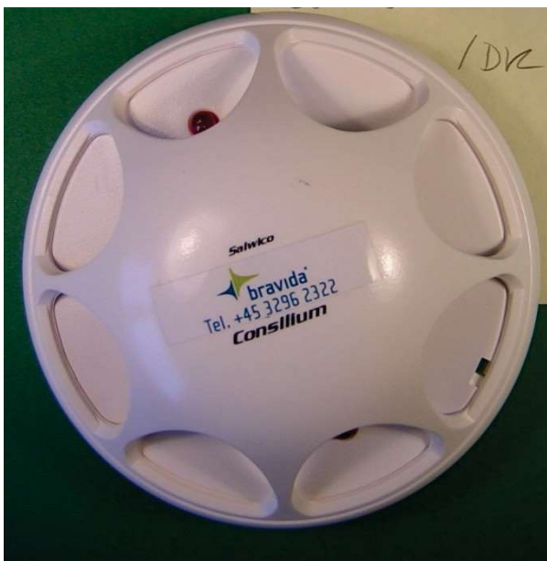
Billede 4: Kategori 1 røgedetektor med typebetegnelsen IA-130 (symbolet for ioniserende stråling findes på bagsiden).
