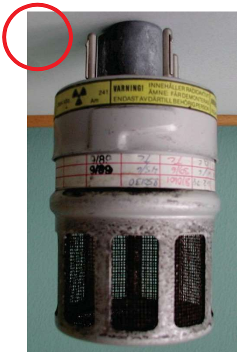
Billede 4: Kategori 1 røgedetektor med typebetegnelsen IA-130 (symbolet for ioniserende stråling findes på bagsiden).
