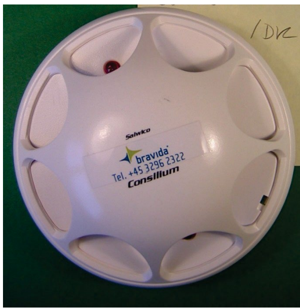
Billede 4: Kategori 1 røgdetektor med typebetegnelsen IA-130 (symbolet for ioniserende stråling findes på bagsiden).
